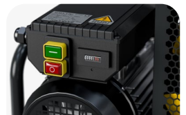
Betriebsstundenzähler Nur für einphasige Elektromotoren
